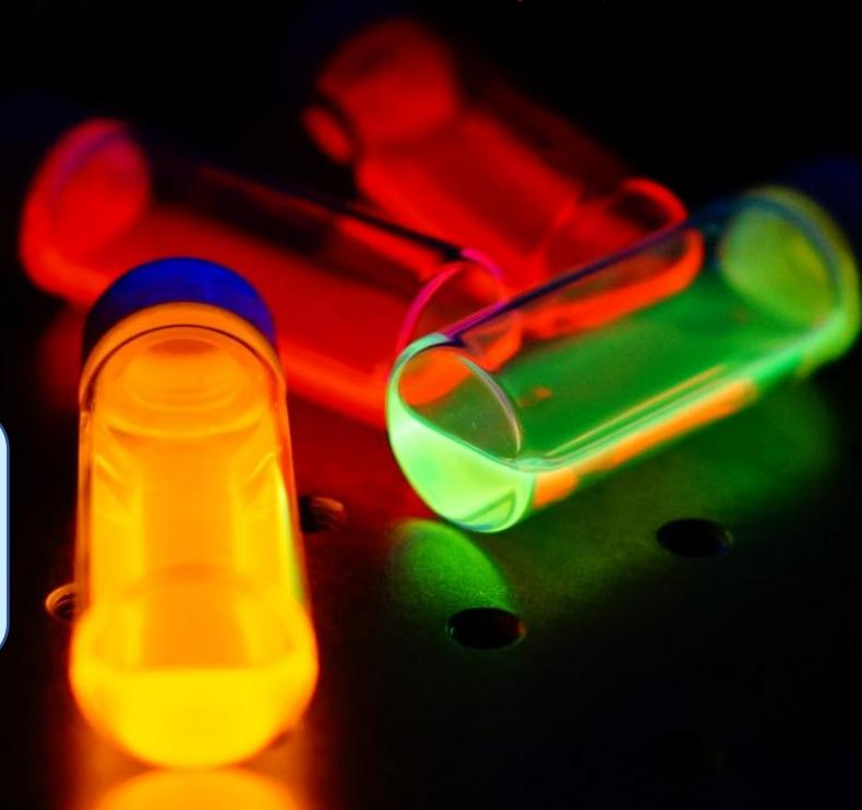
この研究室は、“ナノサイズの材料のかたちと機能”を研究する研究室で、実空間で観察して(目で見て、手で触って)、理論に基づいた直観で、ナノの“ものづくり”をします。たとえば、よく光る半導体ナノ粒子を合成しています。Ag, In, Znの金属酢酸塩とチオ尿素を、有機溶媒中250°Cで反応させると、このような組成の複合金属硫化物ナノ粒子が生成し、電子顕微鏡で観察すると、5 nm程度のきれいにサイズのそろったナノ粒子が生成します。この“ZnAgInSナノ粒子”は、この写真のように、粒子組成によって赤～緑色に発光します。
